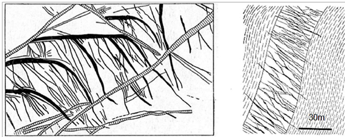
Рисунок 8. Схематический рисунок жил и прожилков и разрез через минерализованные диориты.
