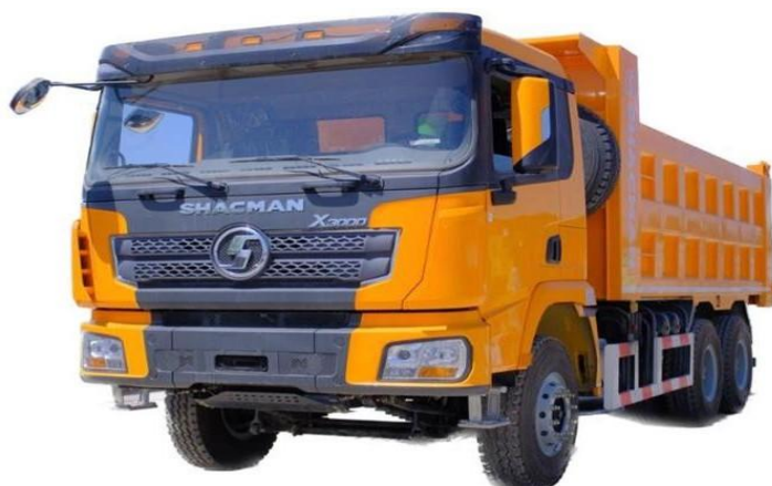
Рисунок 4. Самосвал SHACMAN X3000 грузоподъемностью 25 т.
