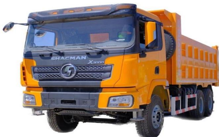
Рисунок 4. Самосвал SHACMAN X3000 грузоподъемностью 25 т.
