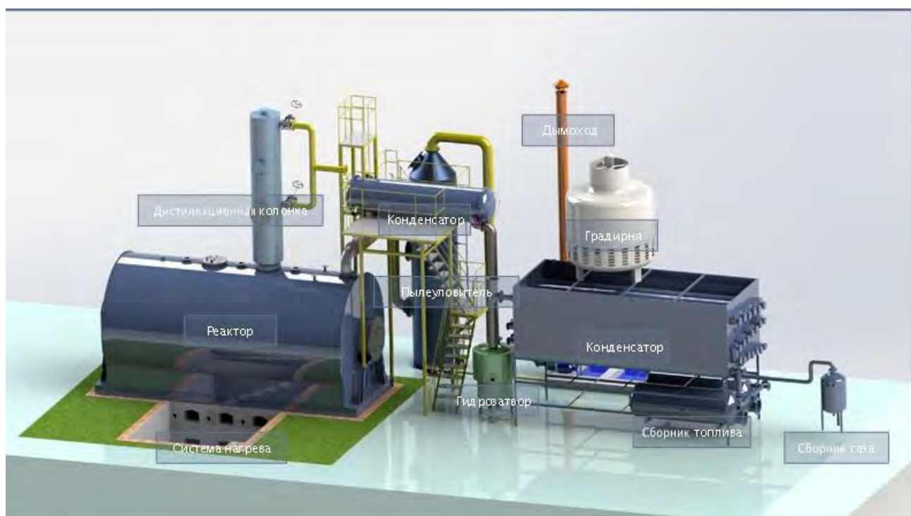
Рис. 2 Ректификационная установка НУ2800*6000
