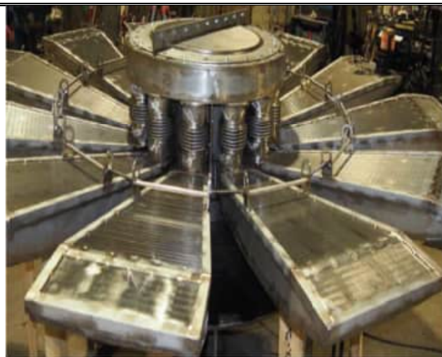
Рисунок 1.4.2.-10. Внешний фактический вид профилированной опорной решетки Johnson Screens SSG в собранном виде [42]
