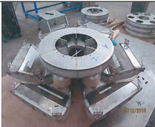
Рисунок 1.4.2.-10. Внешний фактический вид профилированной опорной решетки Johnson Screens SSG в собранном виде [42]
