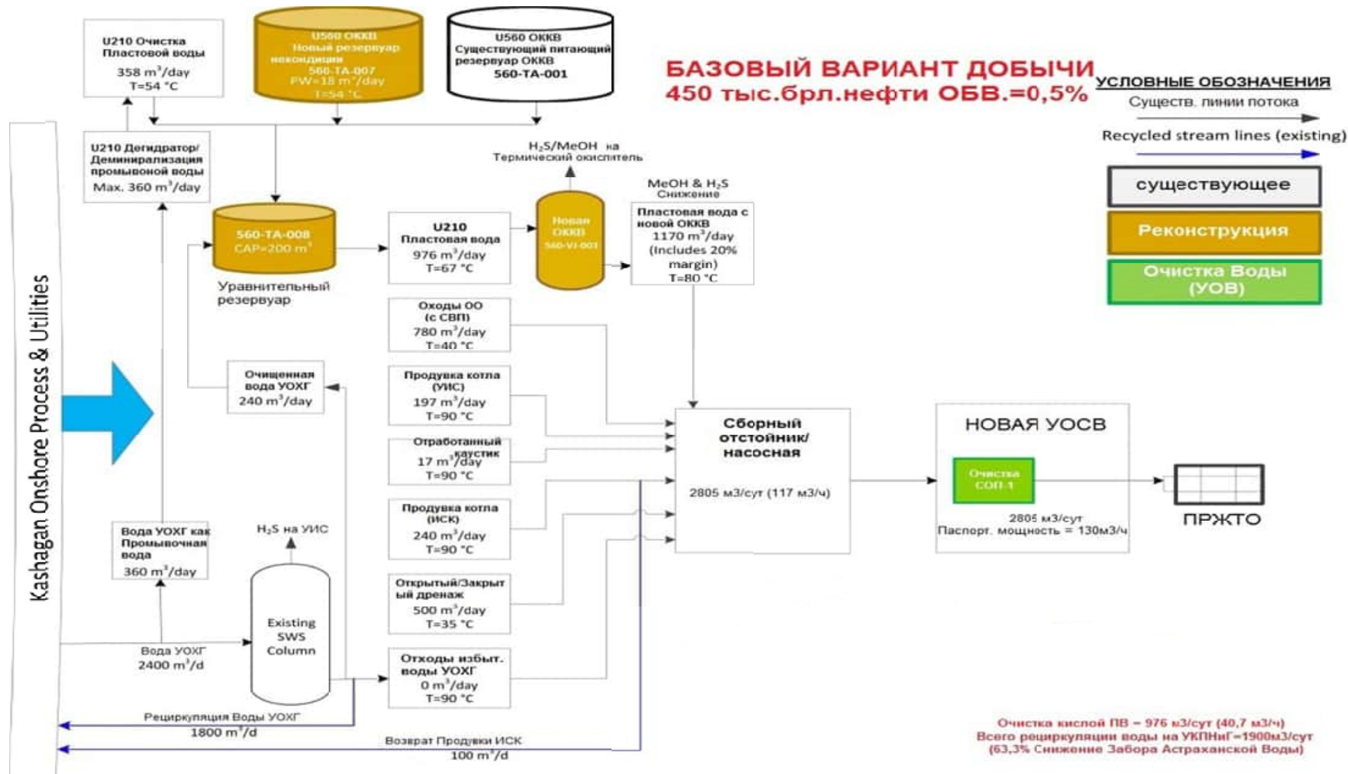
Рисунок 1.4.7.-2. Принципиальная блок-схема ранее модернизированной ОКВ и внеплощадочной УОСВ в условиях эксплуатации объектов при повышении уровня добычи до 450 тыс. барр. в сутки
