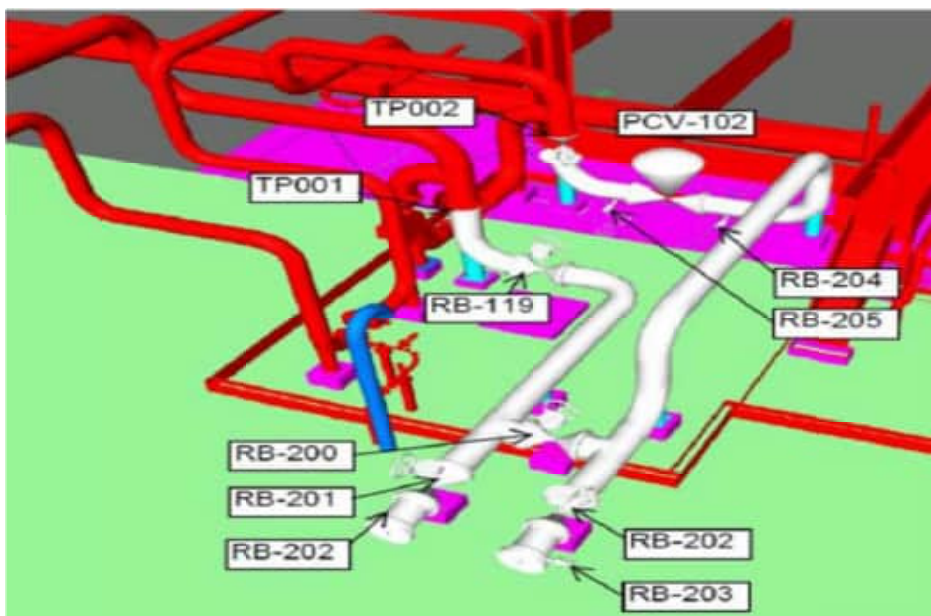
Рисунок 1.4.2.-36. Сборка и установка блока новой трубной обвязки точек подключения
