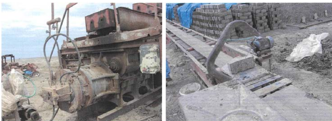
Фото 3, 4. Формовка бруса и резка на кирпичи
