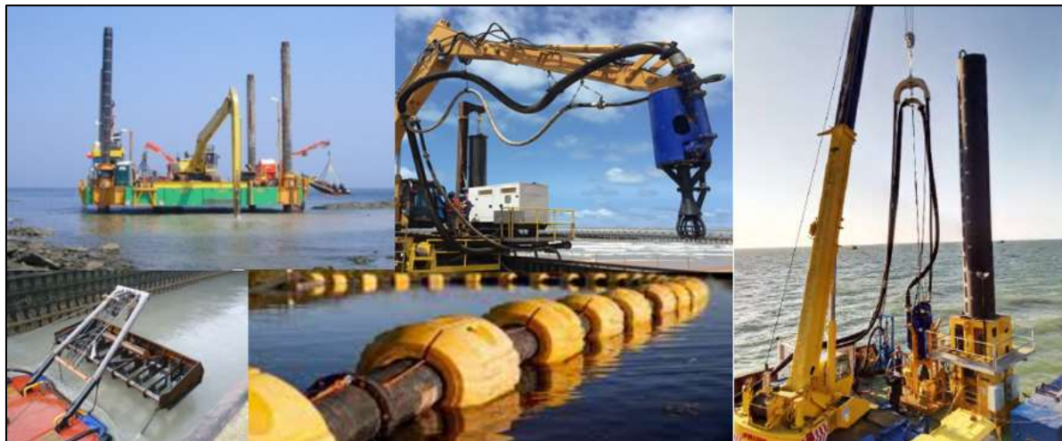
Рисунок 3.1.1 Мобильный кран на плавучей самоподнимающейся платформе с насосом DOP
