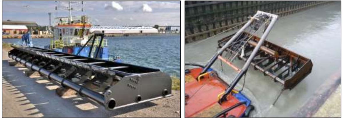
Рисунок 3.1.3 Плуг (слева) и плуг, подвешенный на раме на корме буксирного судна (справа)
