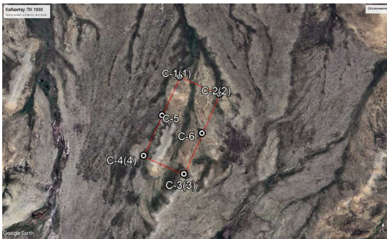
Рис 1.22 Схема участка Кабантау ПК1930 с расположением скважин (на основе космоснимка)
