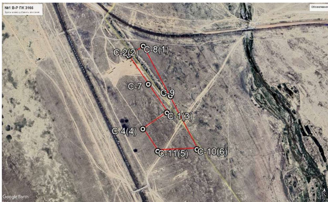
Рис 1.39 Схема участка №1 В-Р ПК3166 с расположением скважин (на основе космоснимка)
