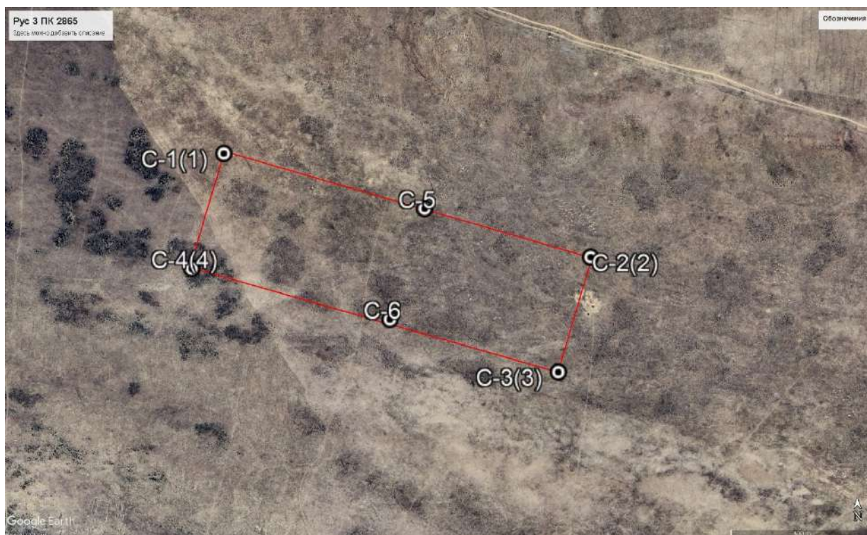
Рис 1.33 Схема участка Рус 3 ПК2865 с расположением скважин (на основе космоснимка)
