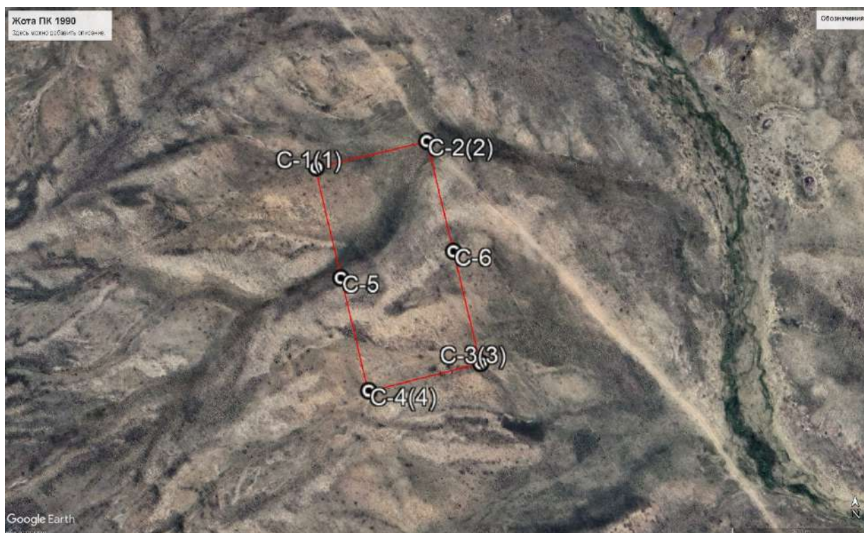
Рис 1.23 Схема участка Жота ПК1990 с расположением скважин (на основе космоснимка)
