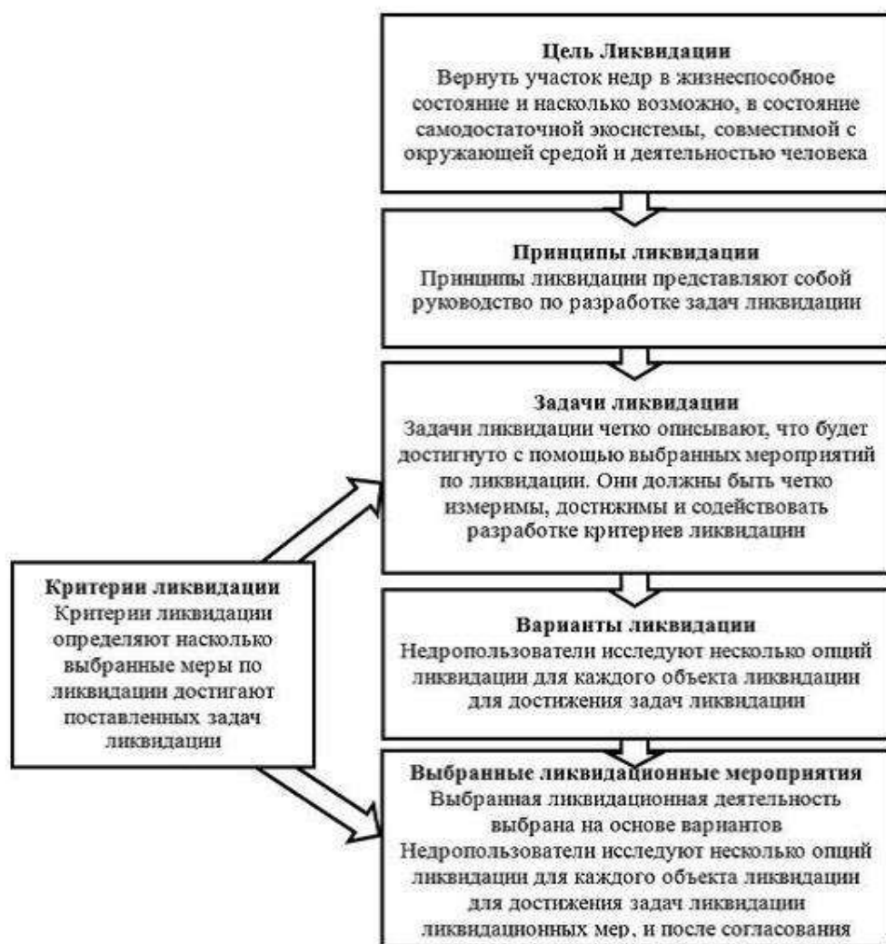
Рис.7.3.1 Схема планирования ликвидации
