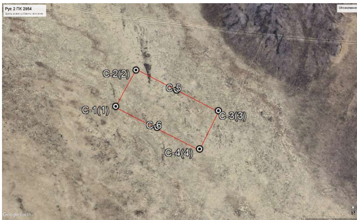
Рис 1.34 Схема участка Рус 2 ПК2954 с расположением скважин (на основе космоснимка)
