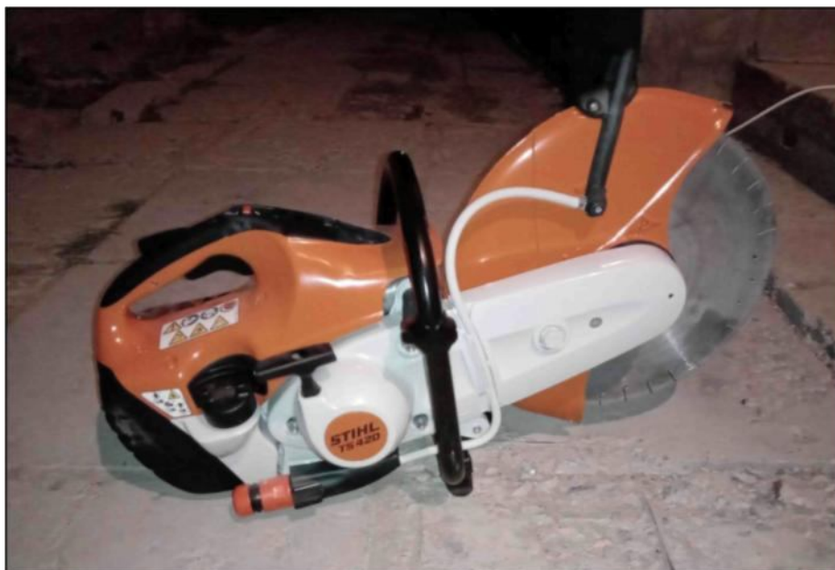
Рис. 5.4 Бензорез для отбора бороздовых проб
