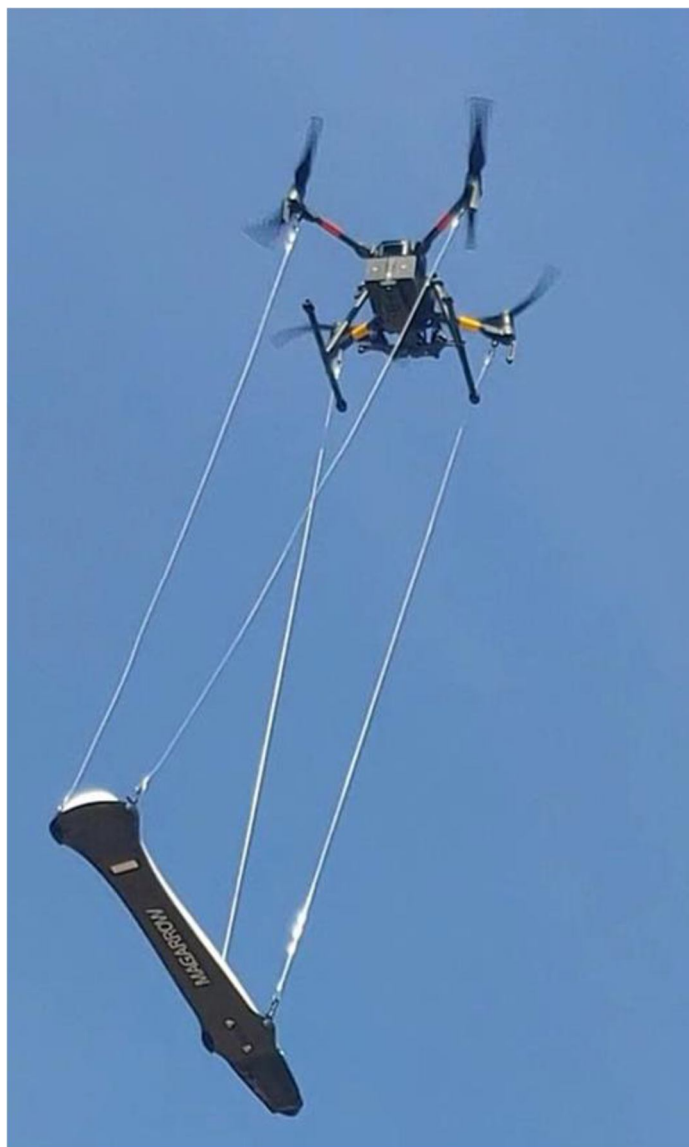
Рис.5.1 Аэромагнитный комплекс DJI M300 RTK + MagArrow
