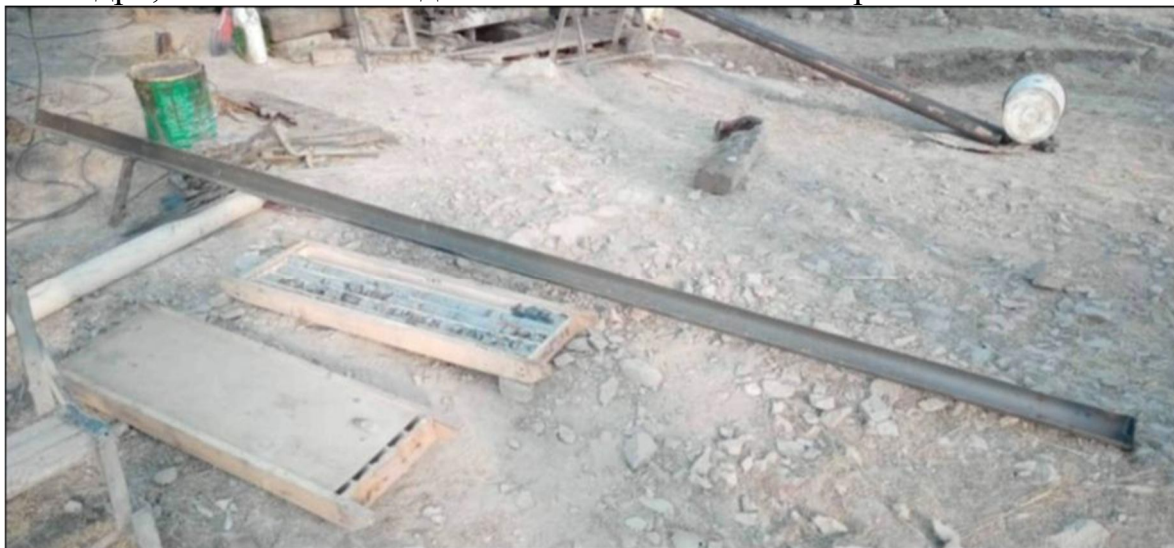
5.5 Желоб для извлечения керна из бурового снаряда
