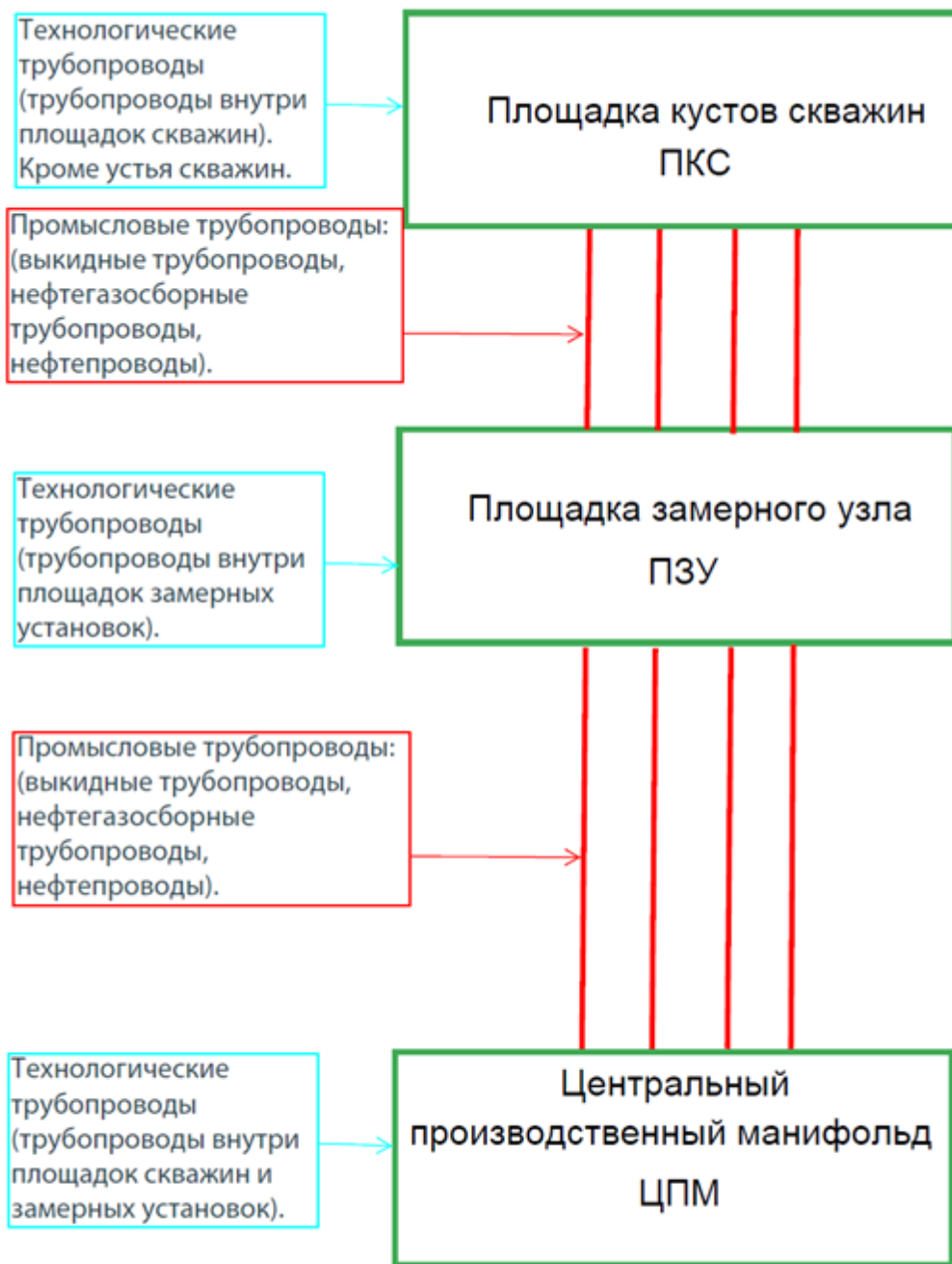
Рисунок 1.4.3.1. Схема технологических и промысловых трубопроводов
