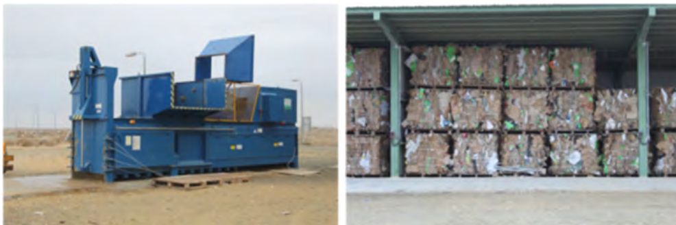
Фото 8 Пакетировочный пресс WHS 650 HDE и спрессованный картон после пресса в виде брикетов на ТЭЦ
