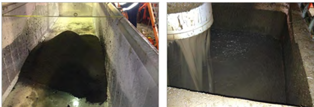
Фото 7 Разделенные фазы бурового шлама – буровой раствор и сухой осадок Установки по переработке и обезвреживанию отходов на ТЭЦ
