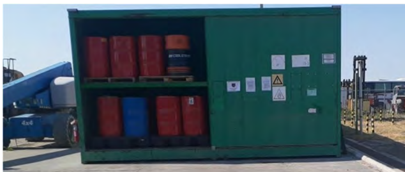
Фото 28 Площадка временного накопления отработанных масел на АРП-1
