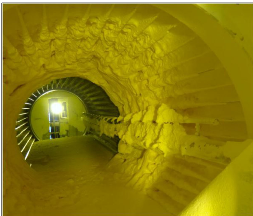
Фото 5 Состояние барабана грануляции при сбоях технологического режима
