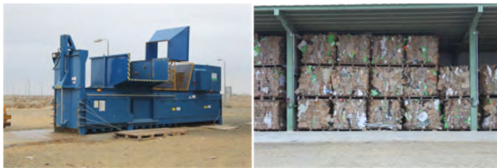
8 -фотосурет WHS 650 HDE түйетін пресс және пресстелген картон ТЭО-да престен кейінгі брикеттер түрінде
