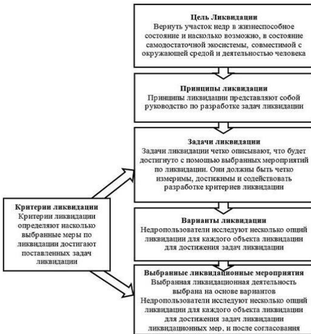
Рис.7.3.1 Схема планирования ликвидации
