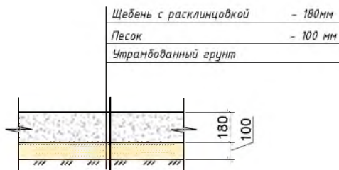
Конструкция покрытия проезда
