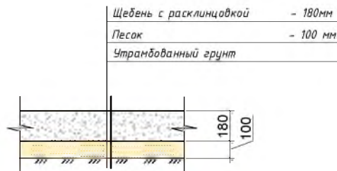
Конструкция покрытия проезда
