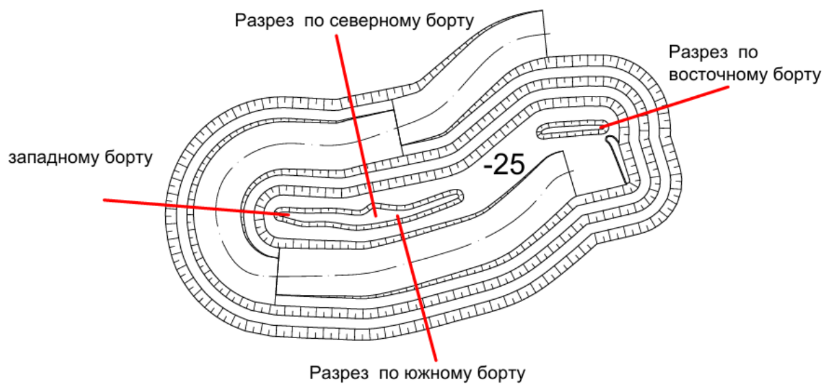
Рисунок 3.1. Разрезы для оценки устойчивости бортов
