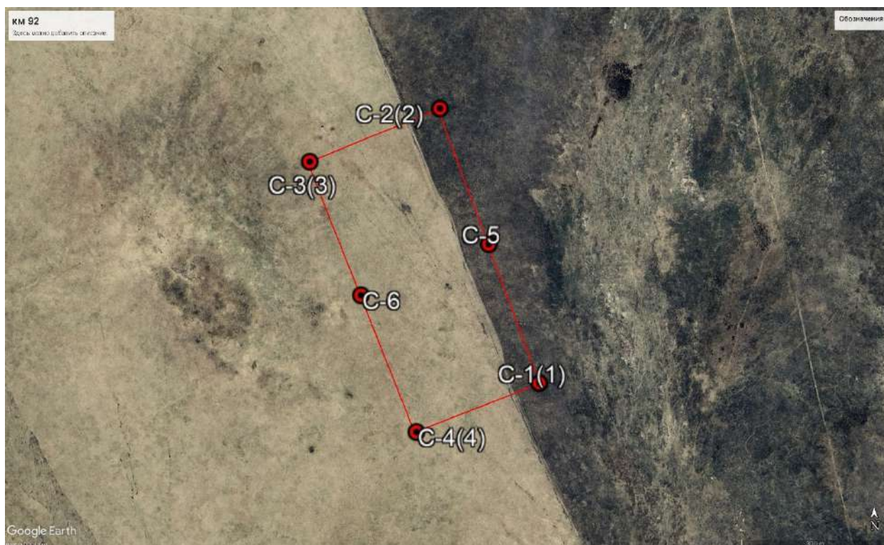
Рис 1.14 Схема участка «км 92» с расположением скважин (на основе космоснимка)
