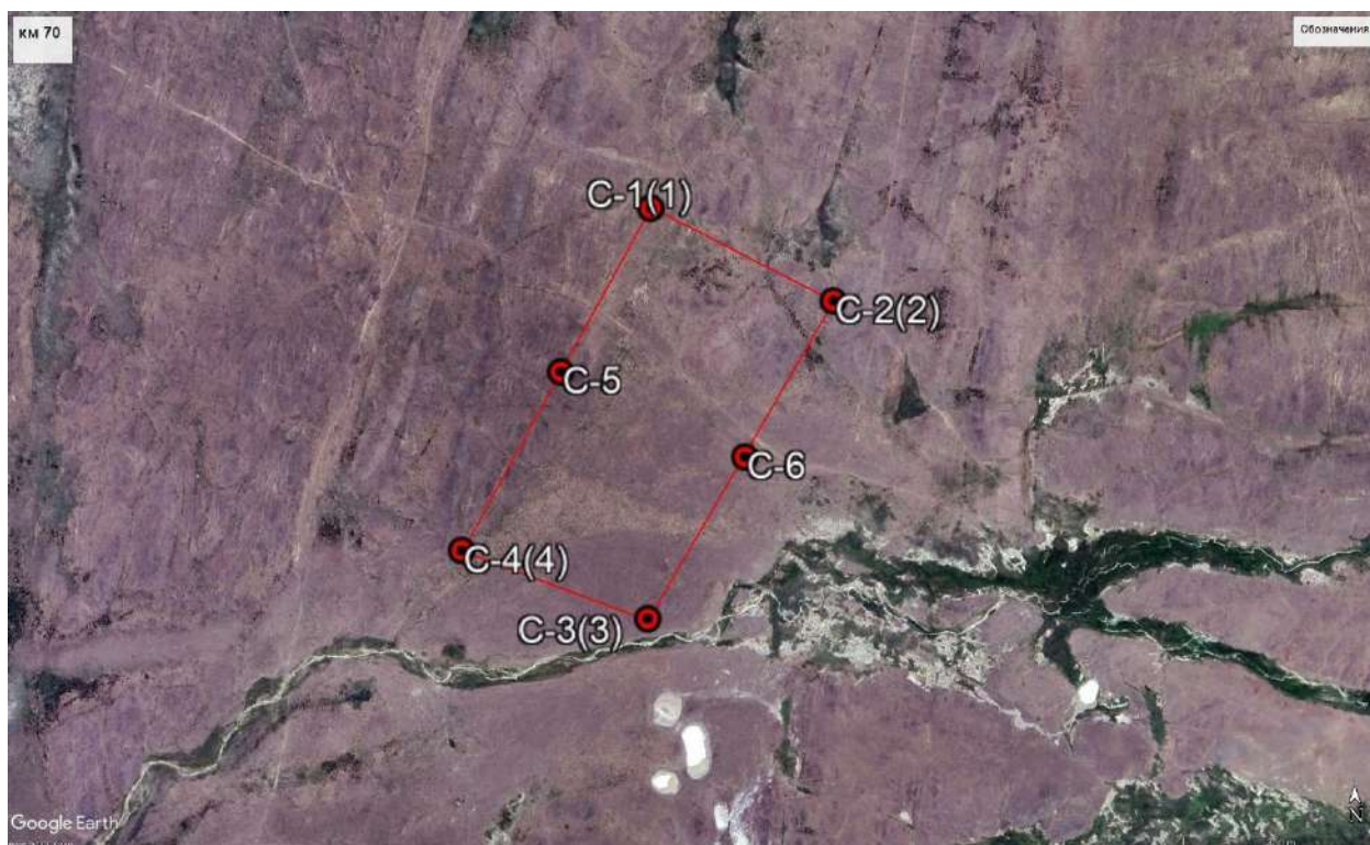
● C-1(1) -местоположение и номер скважины, в скобках - угловой точки Рис 1.10 Схема участка «км 70» с расположением скважин (на основе космоснимка)
