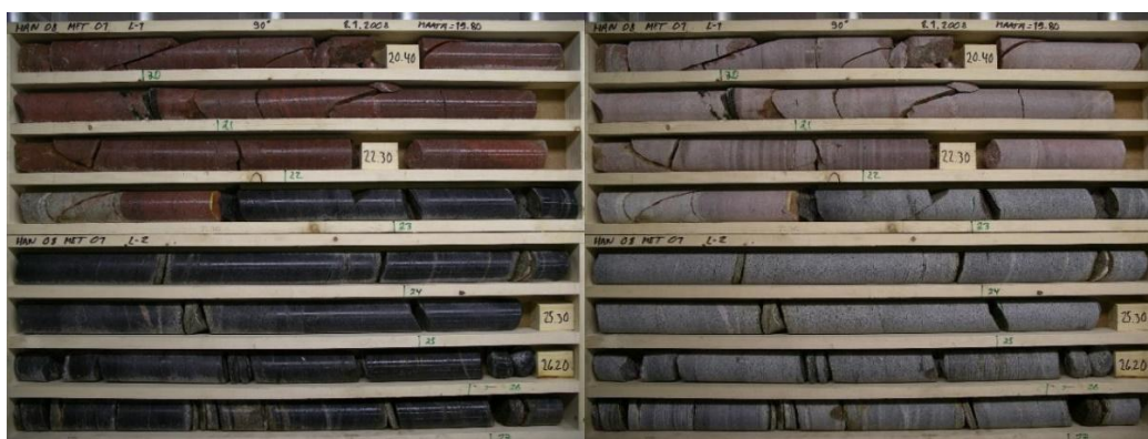
Рис. 8 Фотографии керновых ящиков с мокрым и сухим керном
