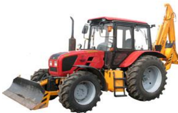
Рисунок 5. Общий вид экскаватора ЭП-25
