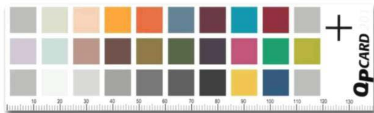
Рис. 3 - Пример цветной/черно-белой контрольной полосы, которая может быть использована для корректировки цветового баланса
