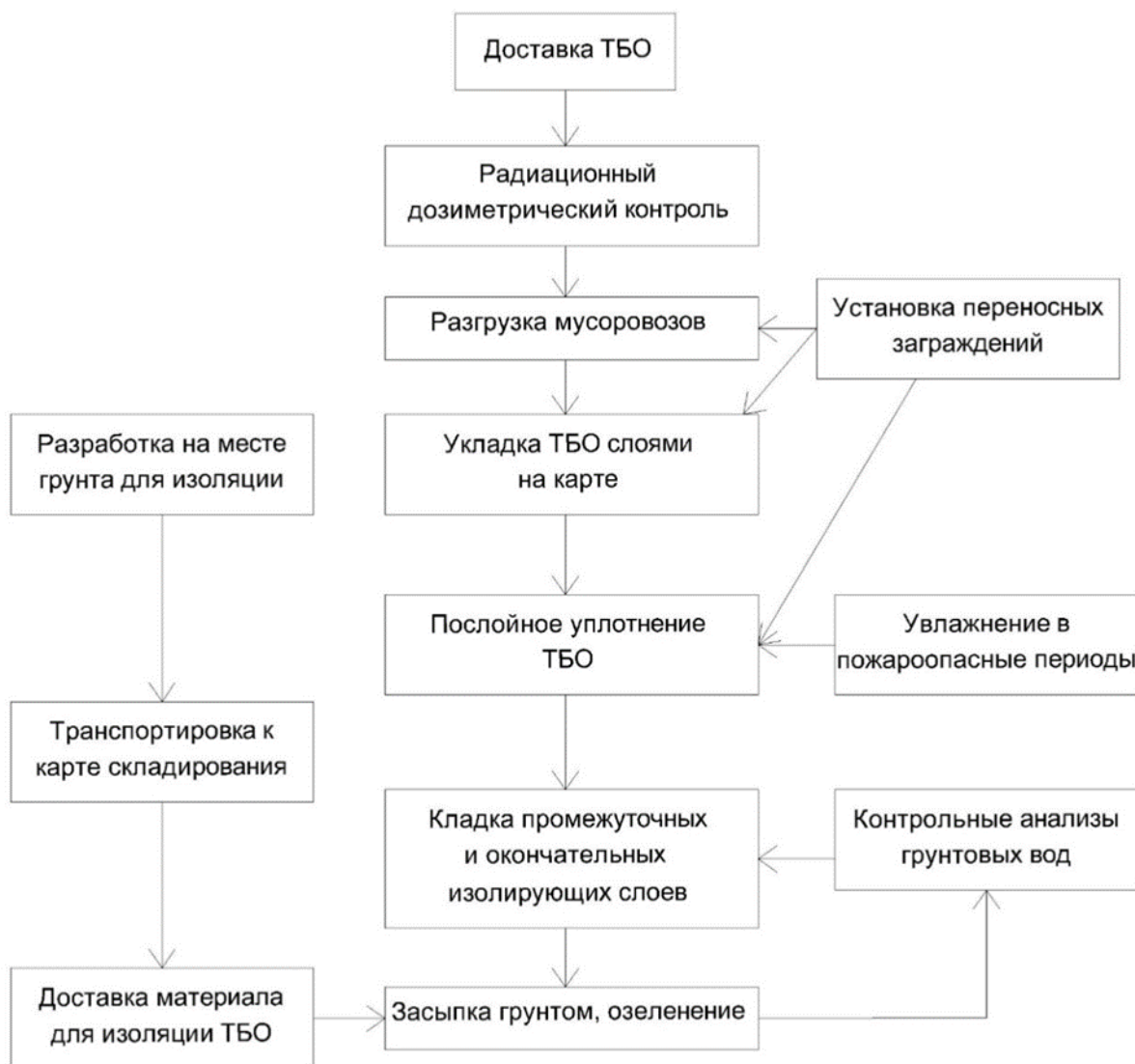
Рисунок -1. Основные виды технологических операций при эксплуатации полигонов ТБО
