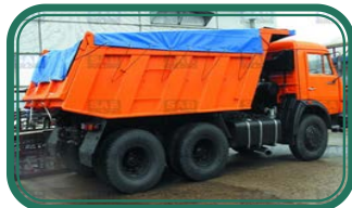
Материалдарды тасымалдайтын көлік құралдарын брезентпен немесе басқа жабынмен жабу/Покрытие транспортных средств, перевозящих материалы, брезентом или другим покрытием
