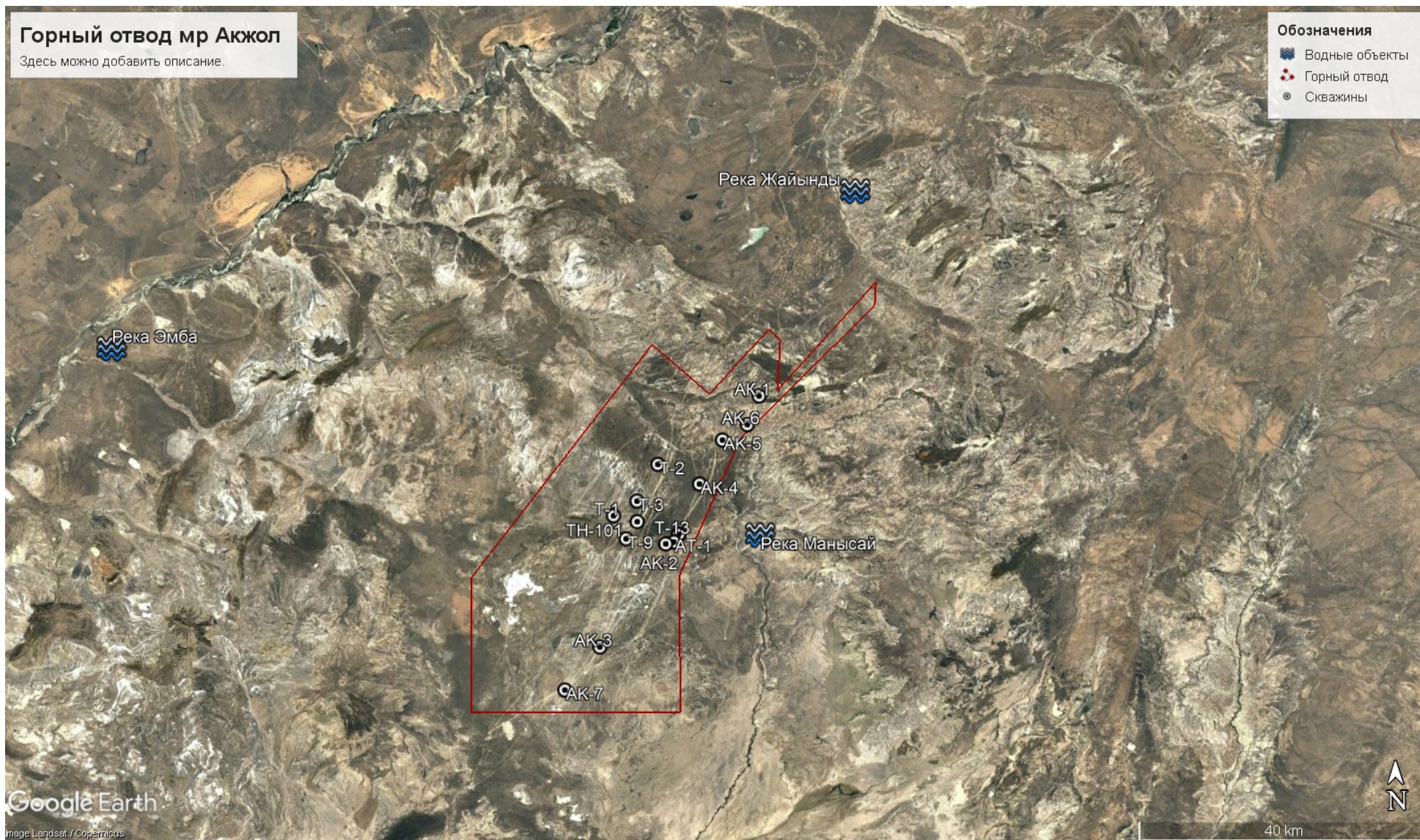
Рис. 1.4. – Карта схема расположения скважин относительно ближайших водных объектов
