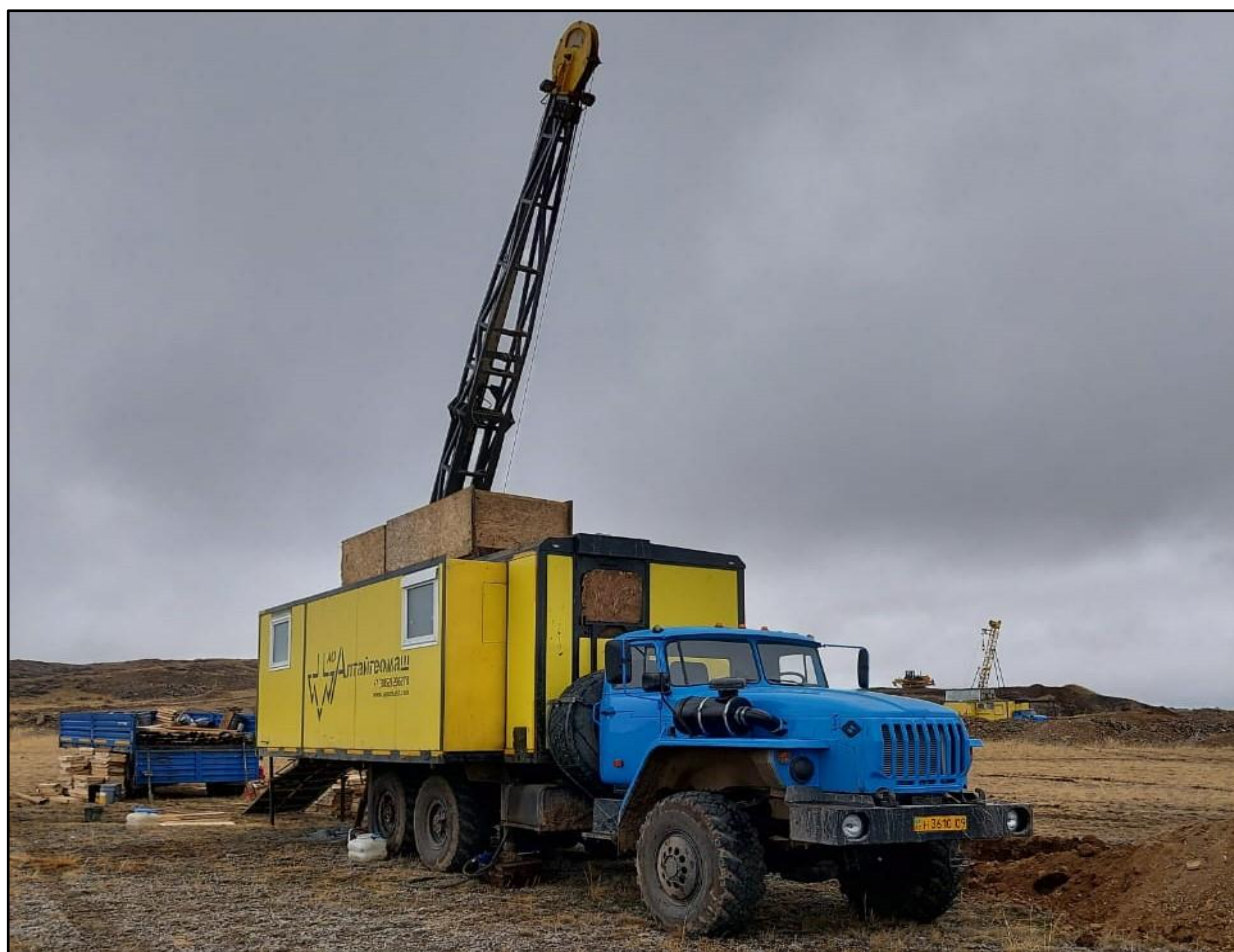
Рис. 5.1 Буровая установка на базе автомобиля УРАЛ 4320
