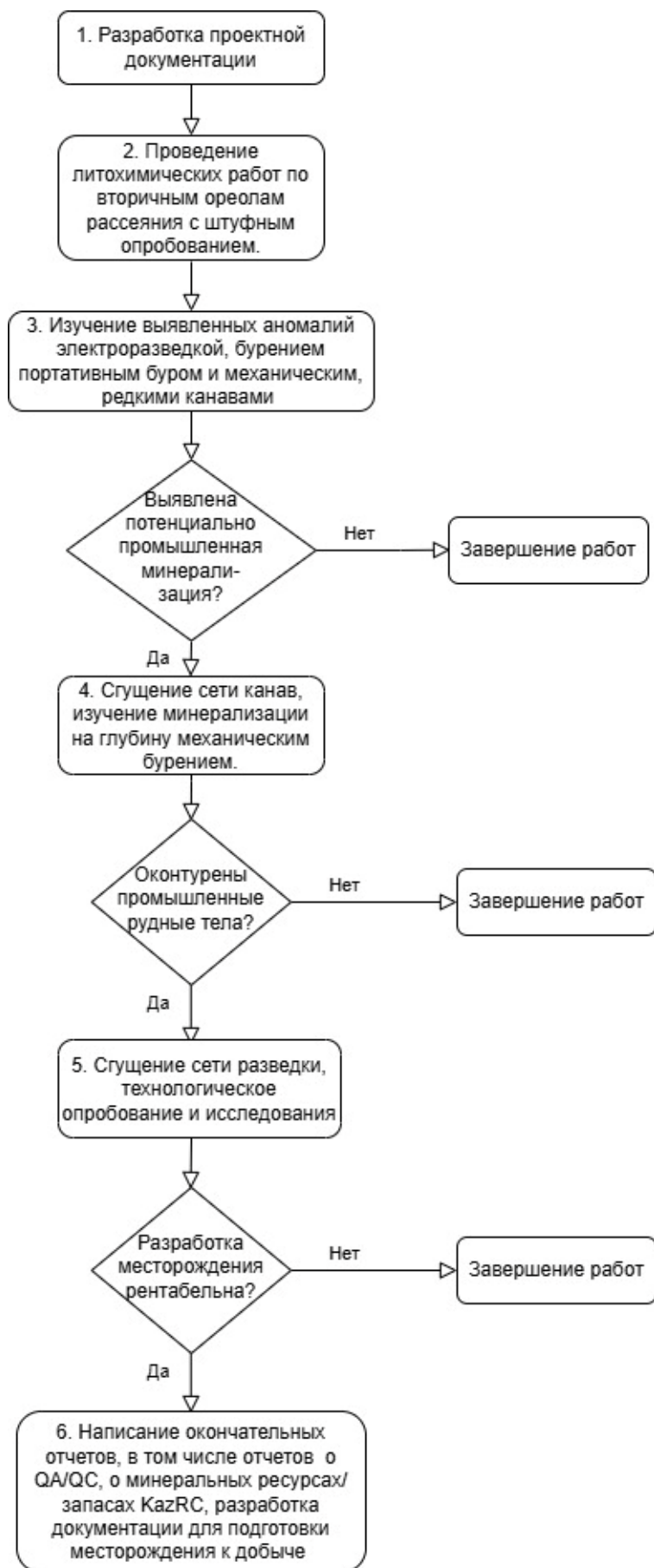
Рисунок 2.1. Блок-схема основных проектируемых геологоразведочных работ
