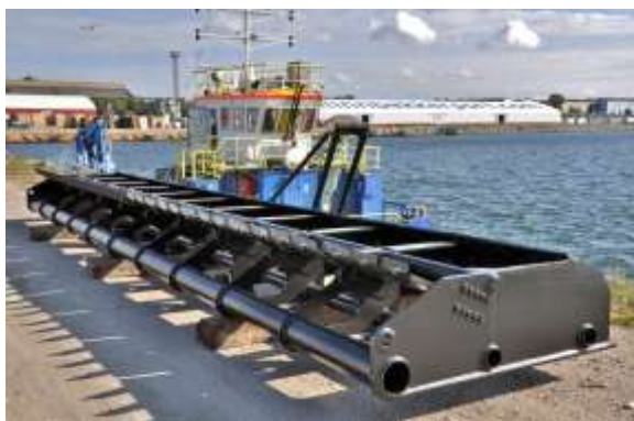
Рис. 3.5 плуг (слева) и плуг, подвешенный на А-образной раме на корме буксирного судна (справа).
