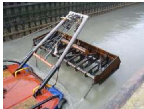
Рис. 3.5 плуг (слева) и плуг, подвешенный на А-образной раме на корме буксирного судна (справа).
