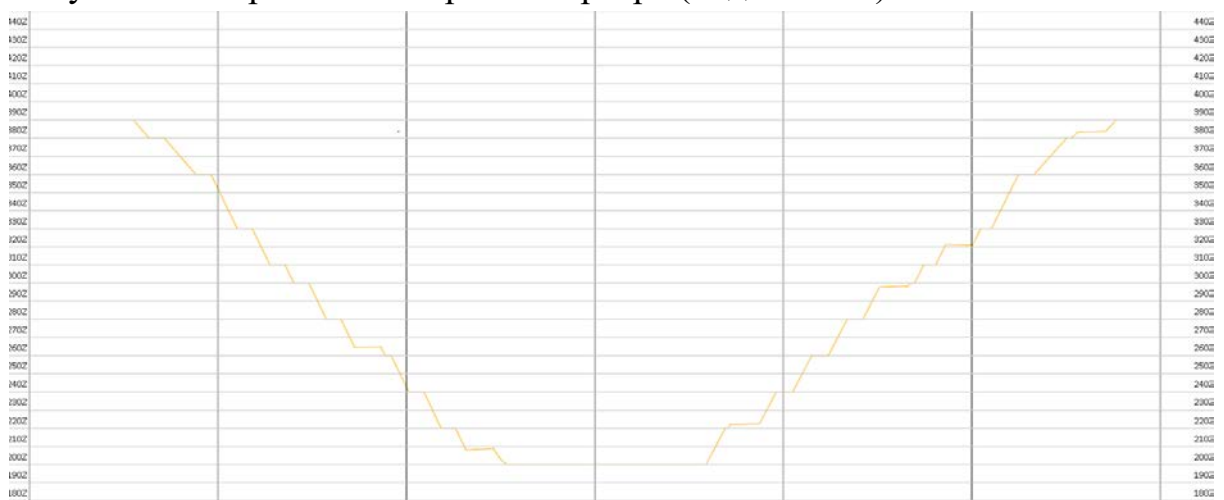
Рисунок 12 - Проектный вариант карьера (вид в разрезе по продольной оси)
