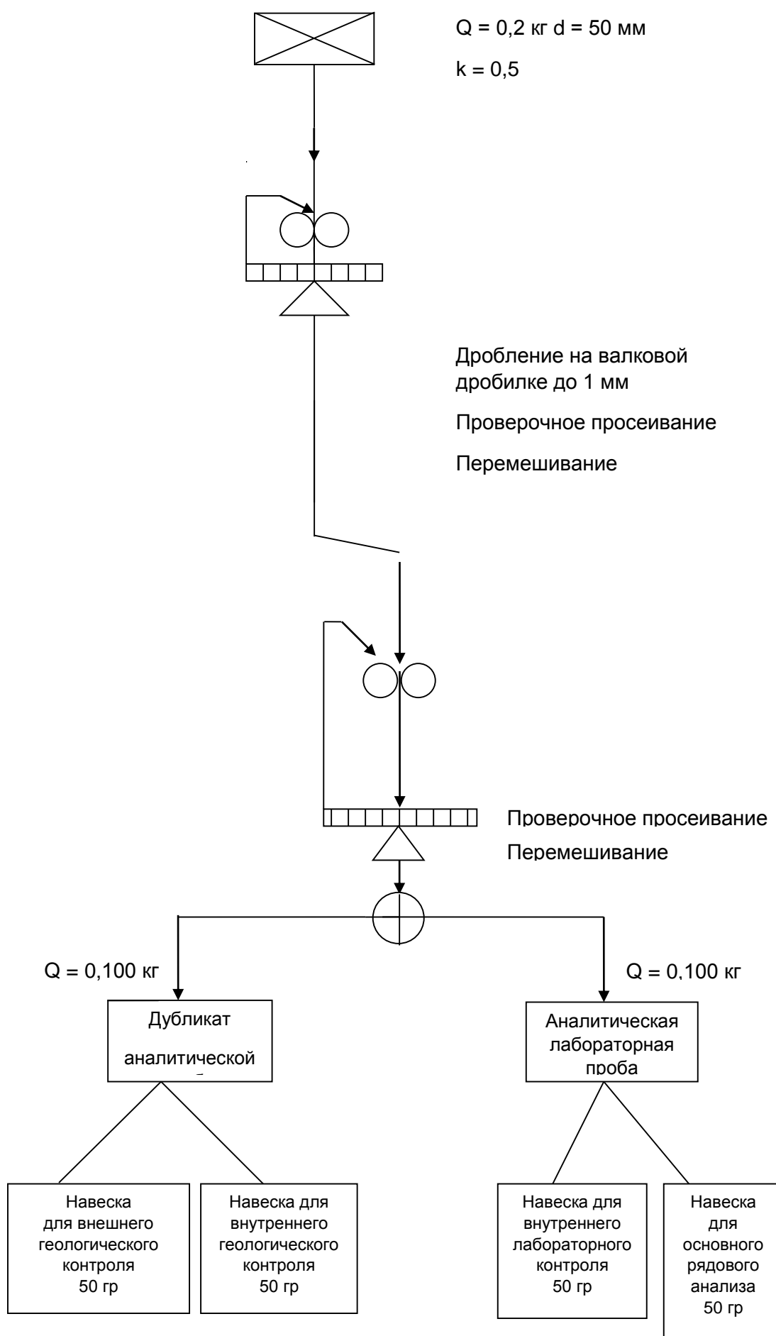
Рис. 4.4 - Схема обработки геохимических проб
