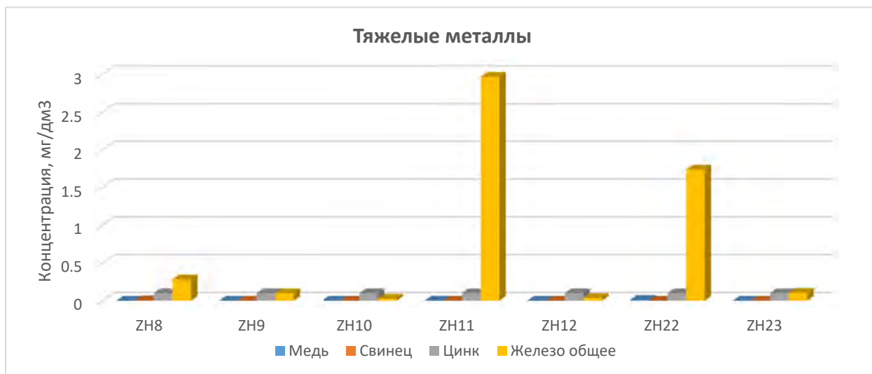
Рисунок 4.6.2. Содержания тяжелых металлов в грунтовых водах. Зима 2026 г.
