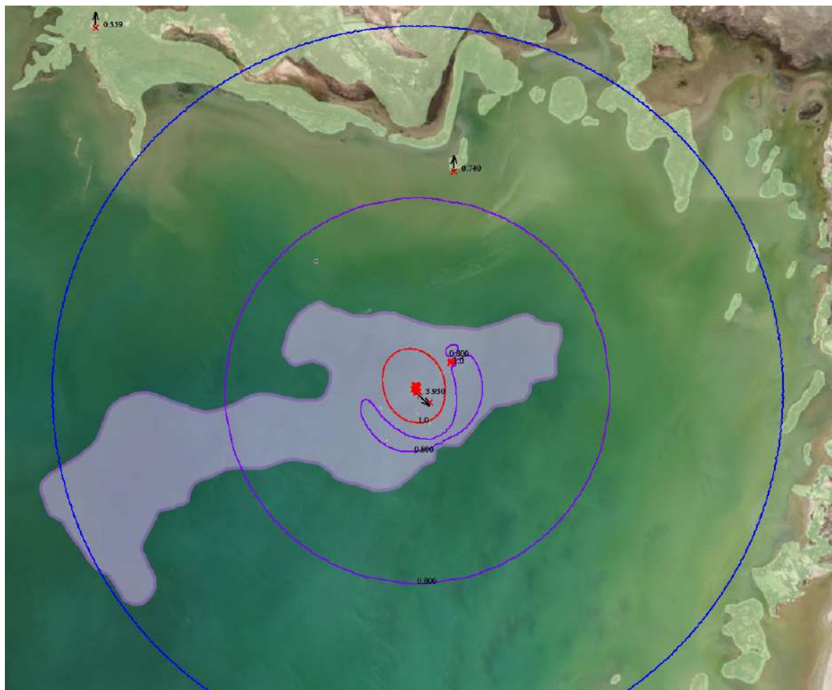
Рисунок 4.3.2 Результаты расчета рассеивания по группе суммации ( \text{NO}_2+\text{SO}_2 ) при кратковременных периодических сбросах на факел
