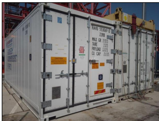
Фото 3 Морозильная установка контейнерного типа
