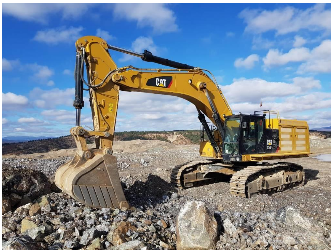
Рисунок 23 - Гидравлический экскаватор САТ-374 с ковшом 3,8 м 3
