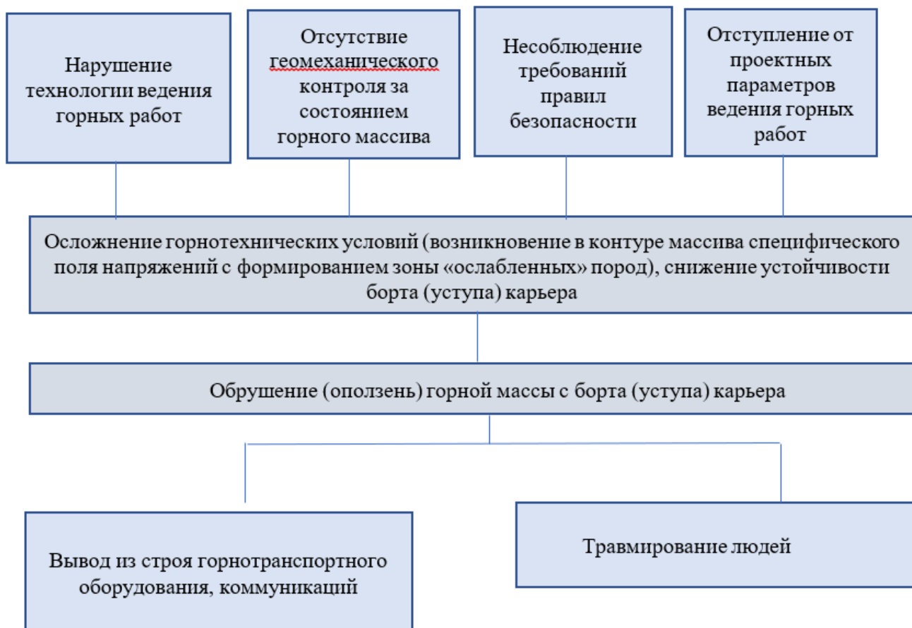
Рисунок 12.1.1.1 – Общая блок-схема анализа вероятных сценариев аварий при обрушении (оползней) горной массы с бортов (уступа) карьера.
