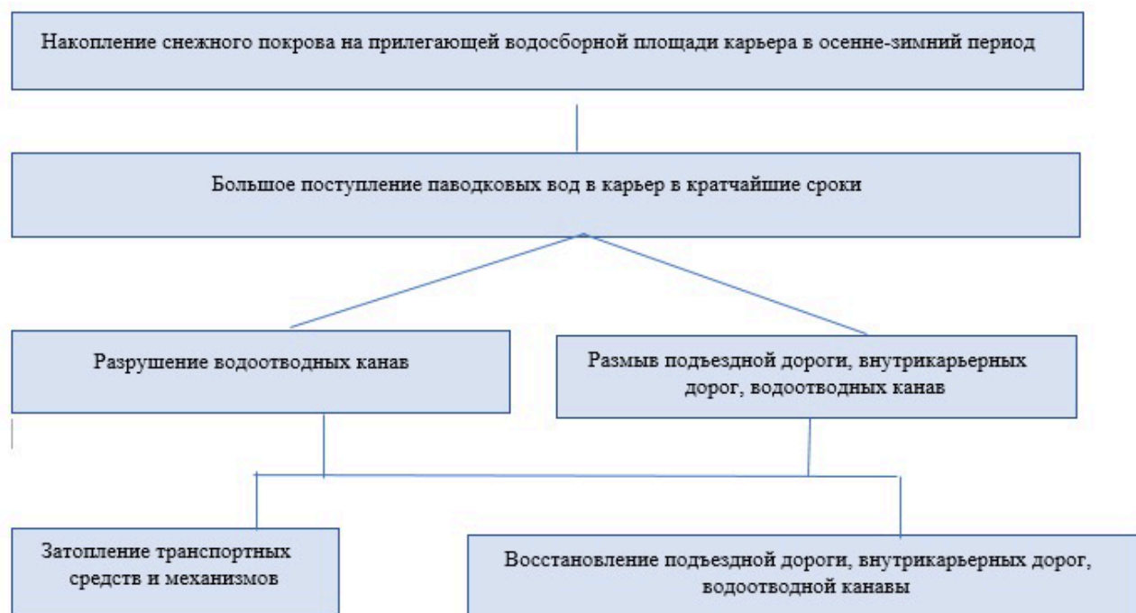
Рис 12.1.1.2 - Блок-схема анализа вероятных сценариев возникновения и развития аварий при затоплении карьера
