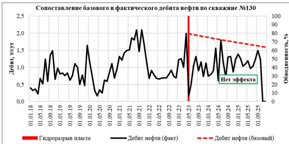
Рис. 3.2.22 – Показатели скважины №130 после проведения ГРП
