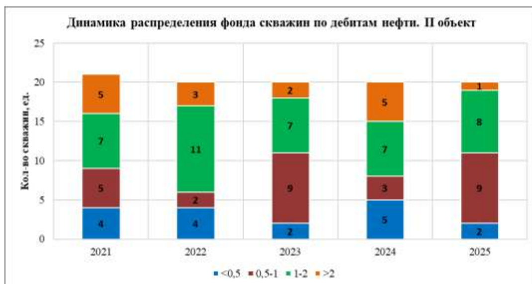
Рис. 3.2.3 – Динамика распределения действующего фонда скважин по дебитам нефти. II объект
