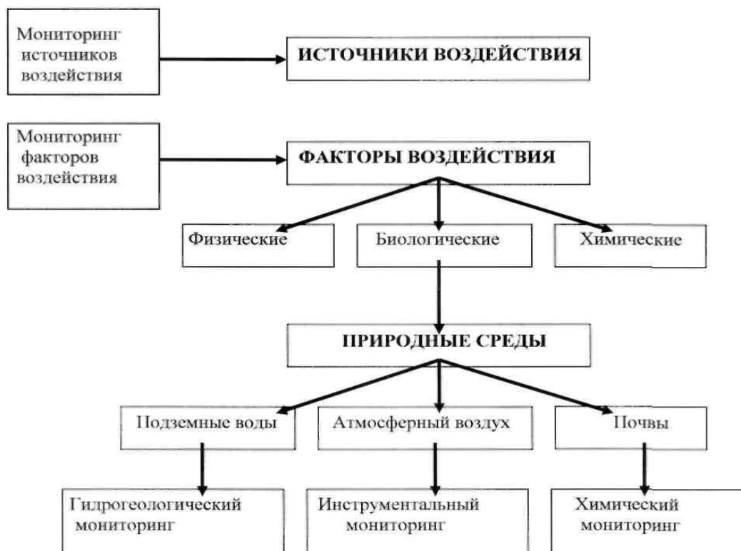
Рисунок 7.1 - Блок-схема проведения мониторинга лабораторией
