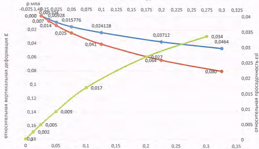
График \epsilon=f(p) зависимости относительной вертикальной деформации ( \epsilon ), относительной просадочности ( \epsilon_{sl} ) от давления (p)
