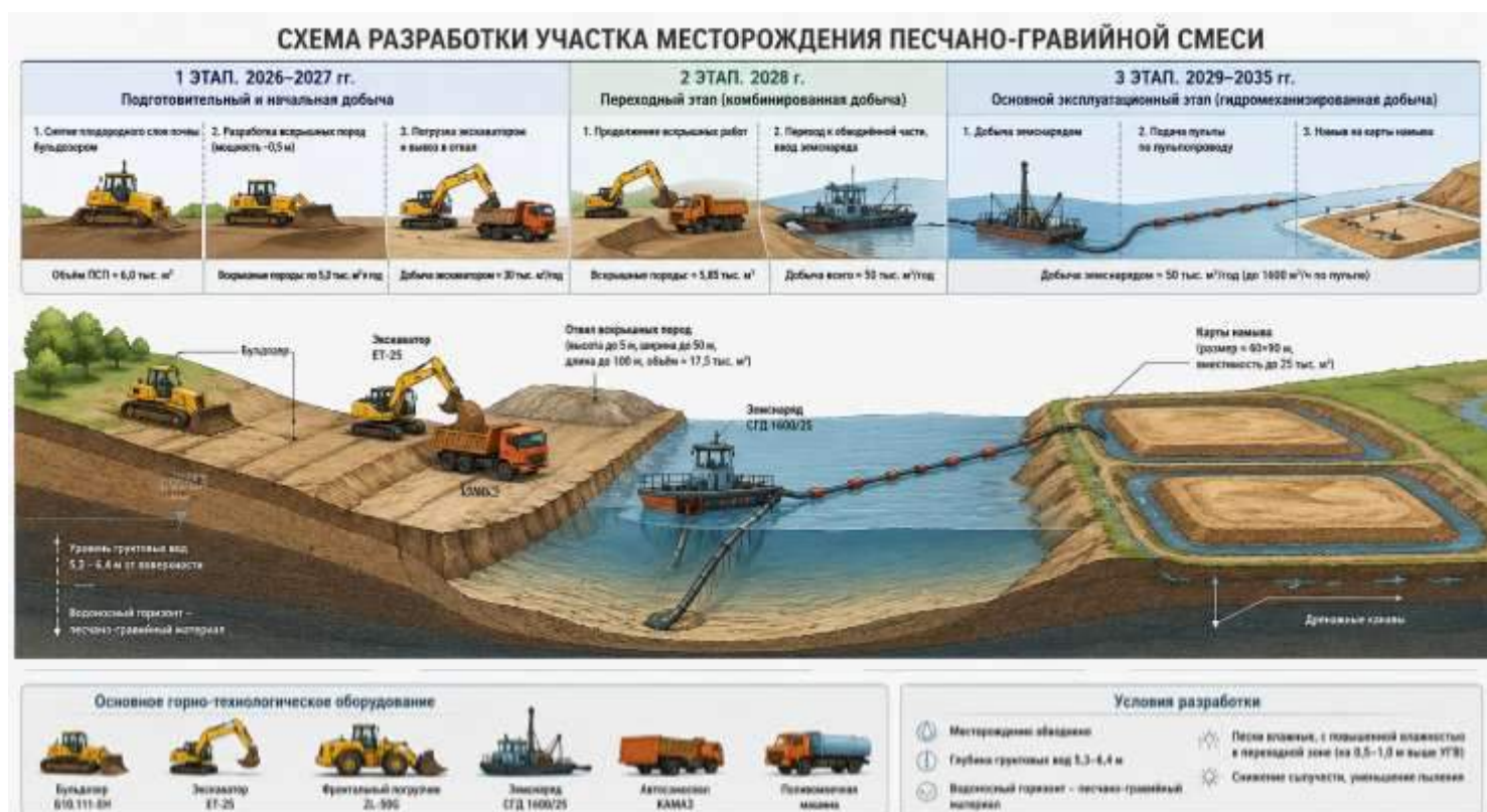
Рисунок 7. Схема разработки участка месторождения песчано-гравийной смеси.
