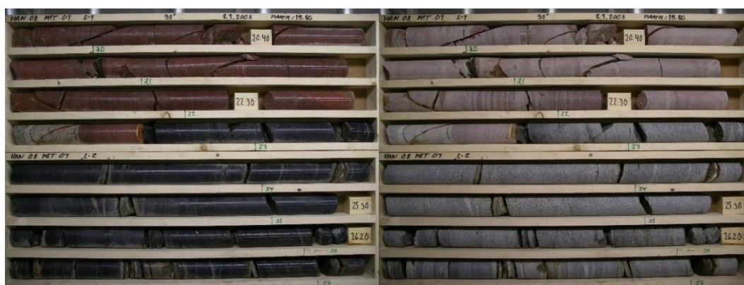
Рис. 4.7.2.1 Фотографии керновых ящиков с мокрым и сухим керном
