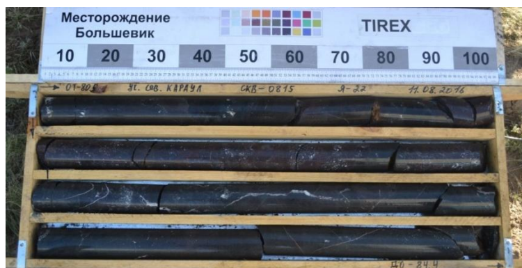
Рис. 4.7.2.2 Пример линейки и цветной/черно-белой контрольной полосы, для корректировки цветового баланса при фотографировании керна
