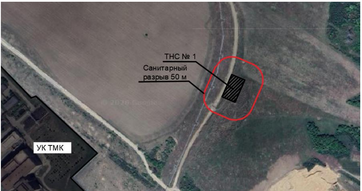
Рисунок 5 Расположение тепловой насосной станции № 1 относительно окружающих объектов
