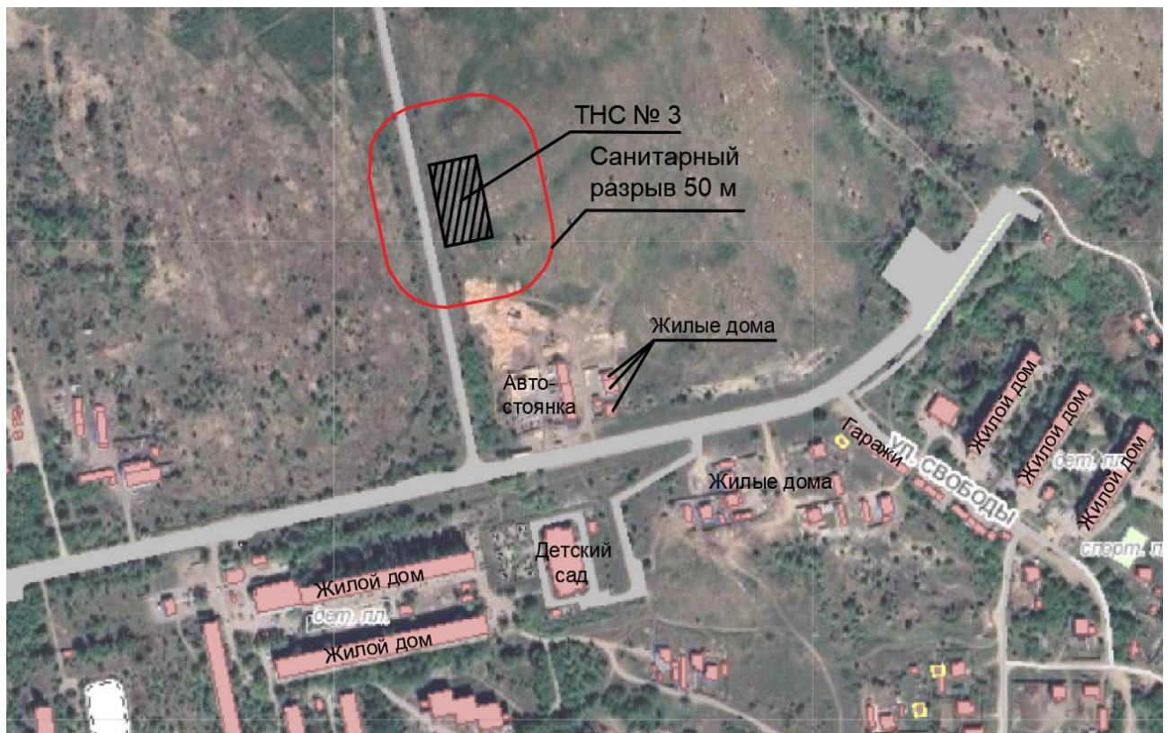
Рисунок 7 Расположение тепловой насосной станции № 3 относительно окружающих объектов
