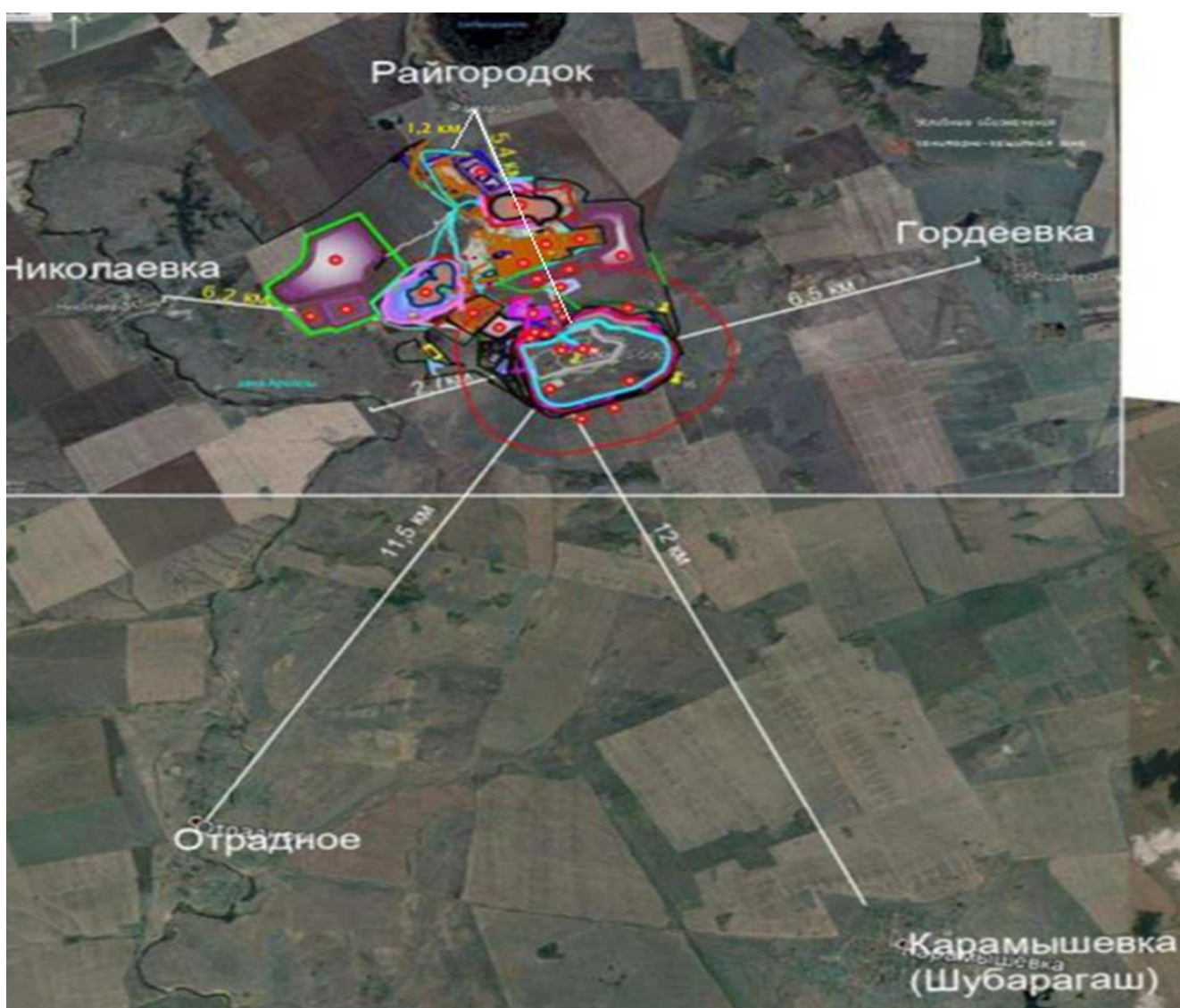
Рисунок 1.5. Расположение хвостохранилища ТОО «RG Gold» к жилой зоне (удаленность хвостохранилища от села Райгородок 5,4 км, от села Николаевка 6,2 км, от села Гордеевка 6,5 км).
