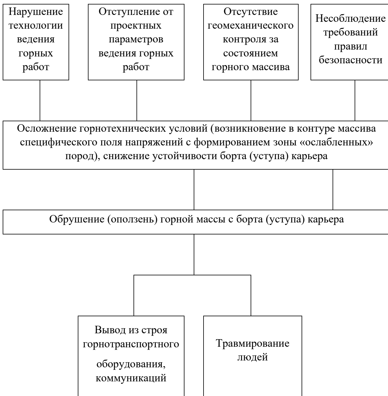
Рис.11.1 - Блок-схема вероятного сценария аварии при обрушении (оползней) горной массы с борта (уступа) карьера
