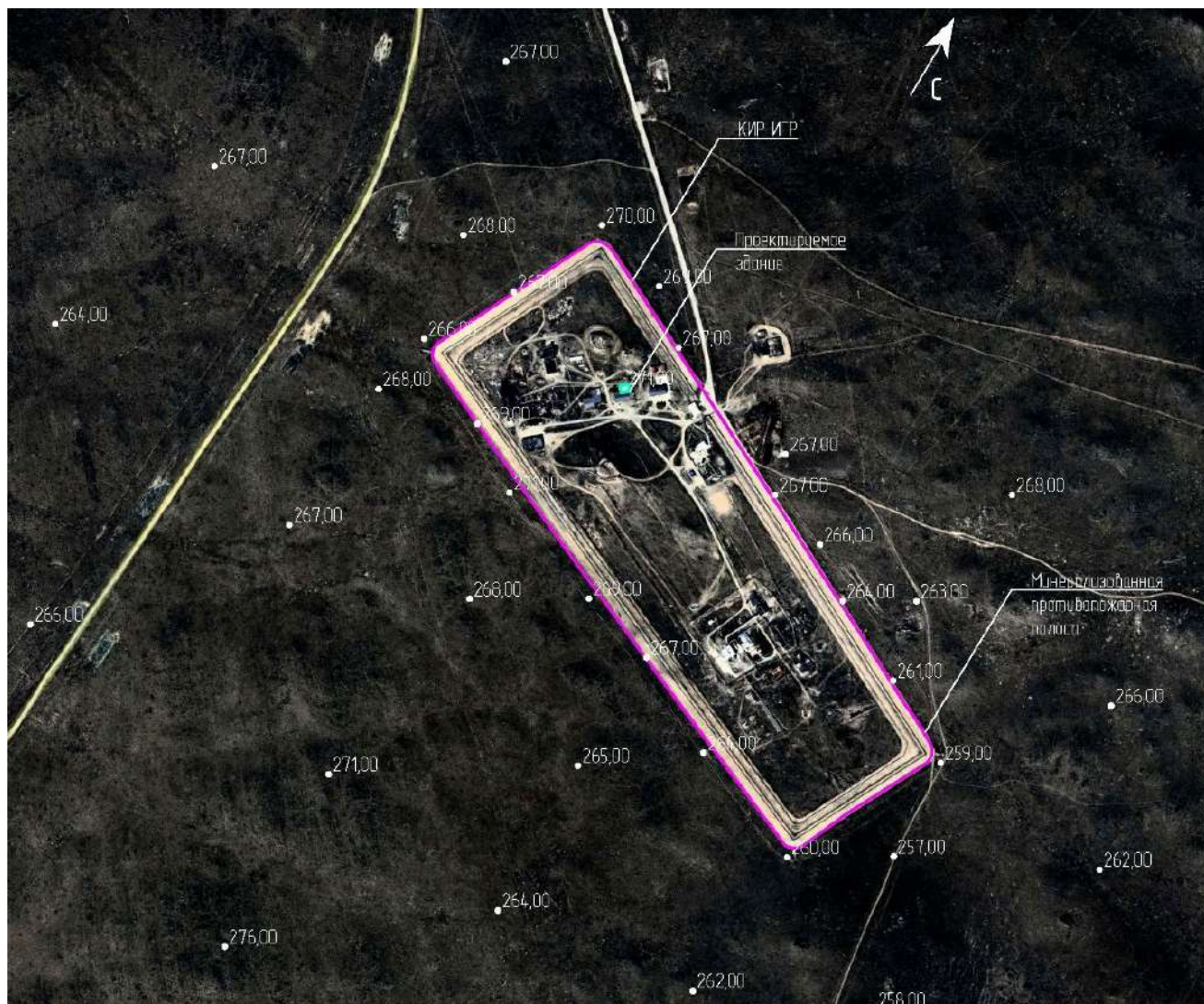
Рисунок 2 – Схема размещения минерализованной противопожарной полосы
