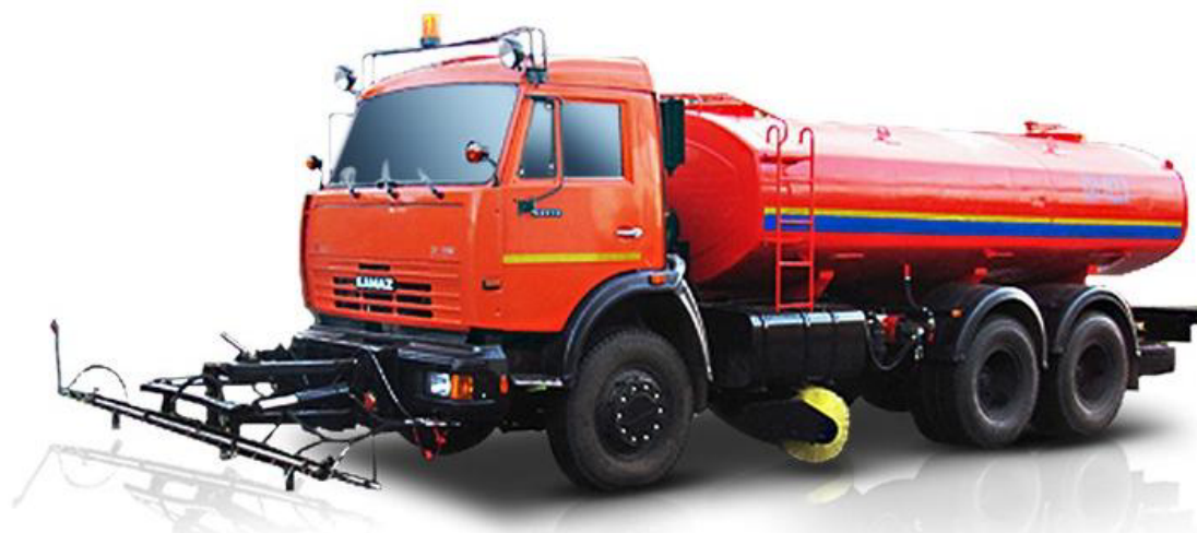
Рис. 4.3 – Поливооросительная машина АПМ-10
