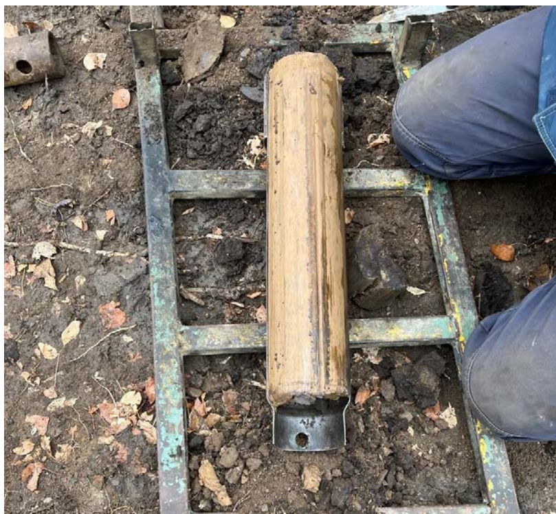
Рис. 2. Отбор проб ненарушенной структуры
