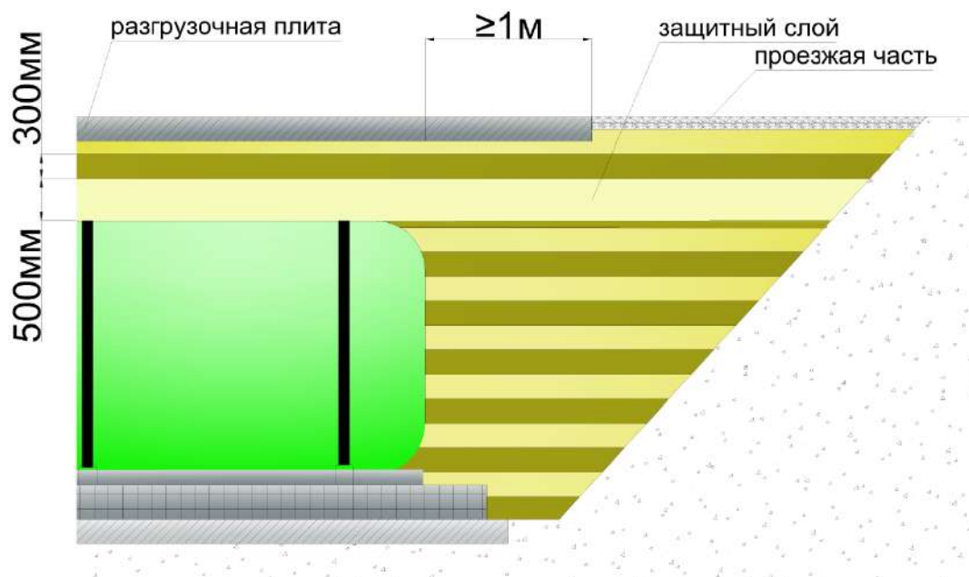
Рисунок 13 – Монтаж корпуса под проезжую часть
