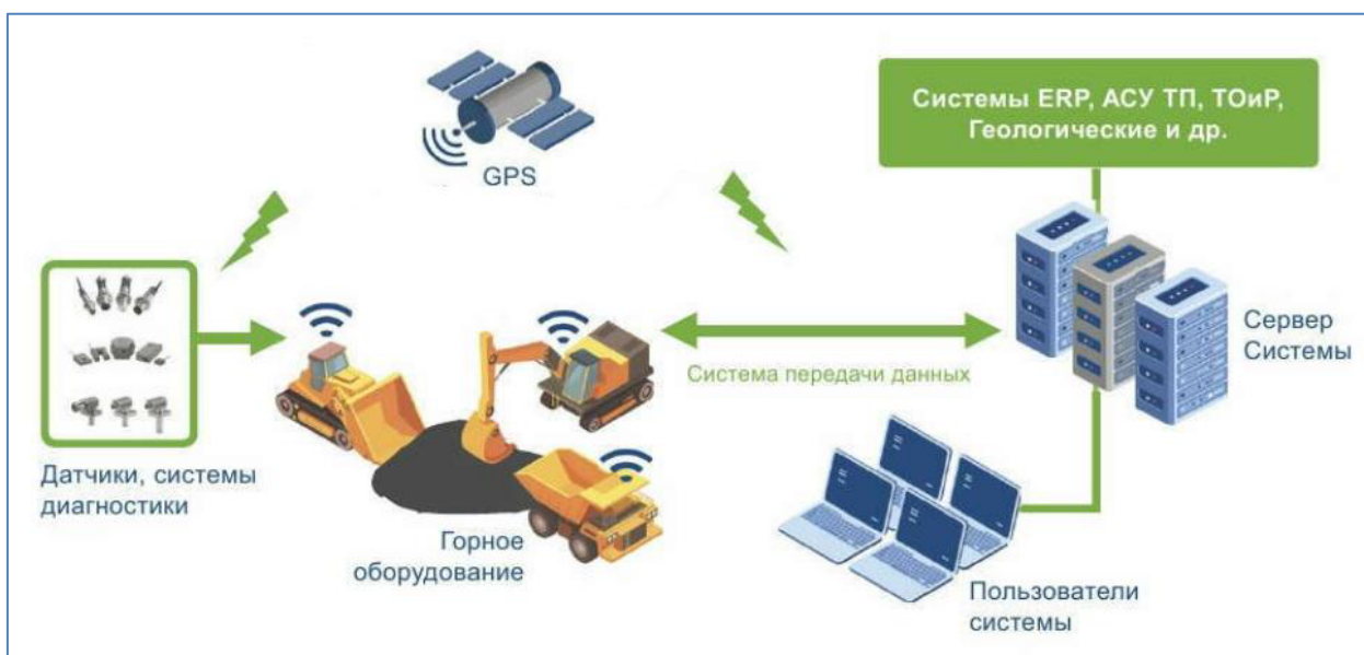
Рис. 3.3 – Типовая схема АСУ горными работами.
