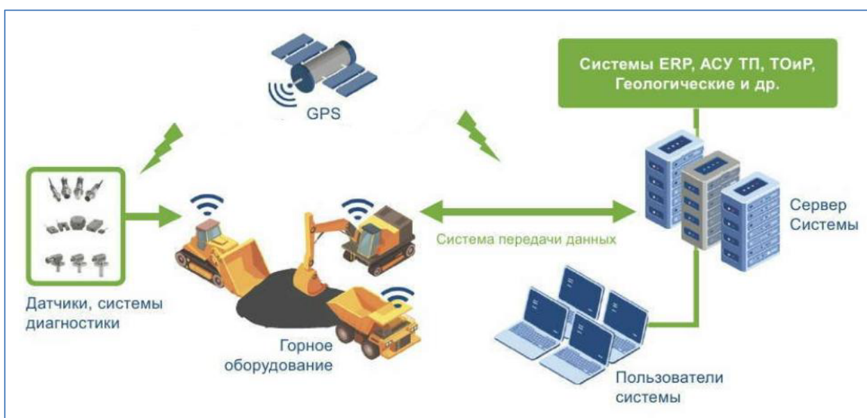
Рис. 3.3 – Типовая схема АСУ горными работами.
