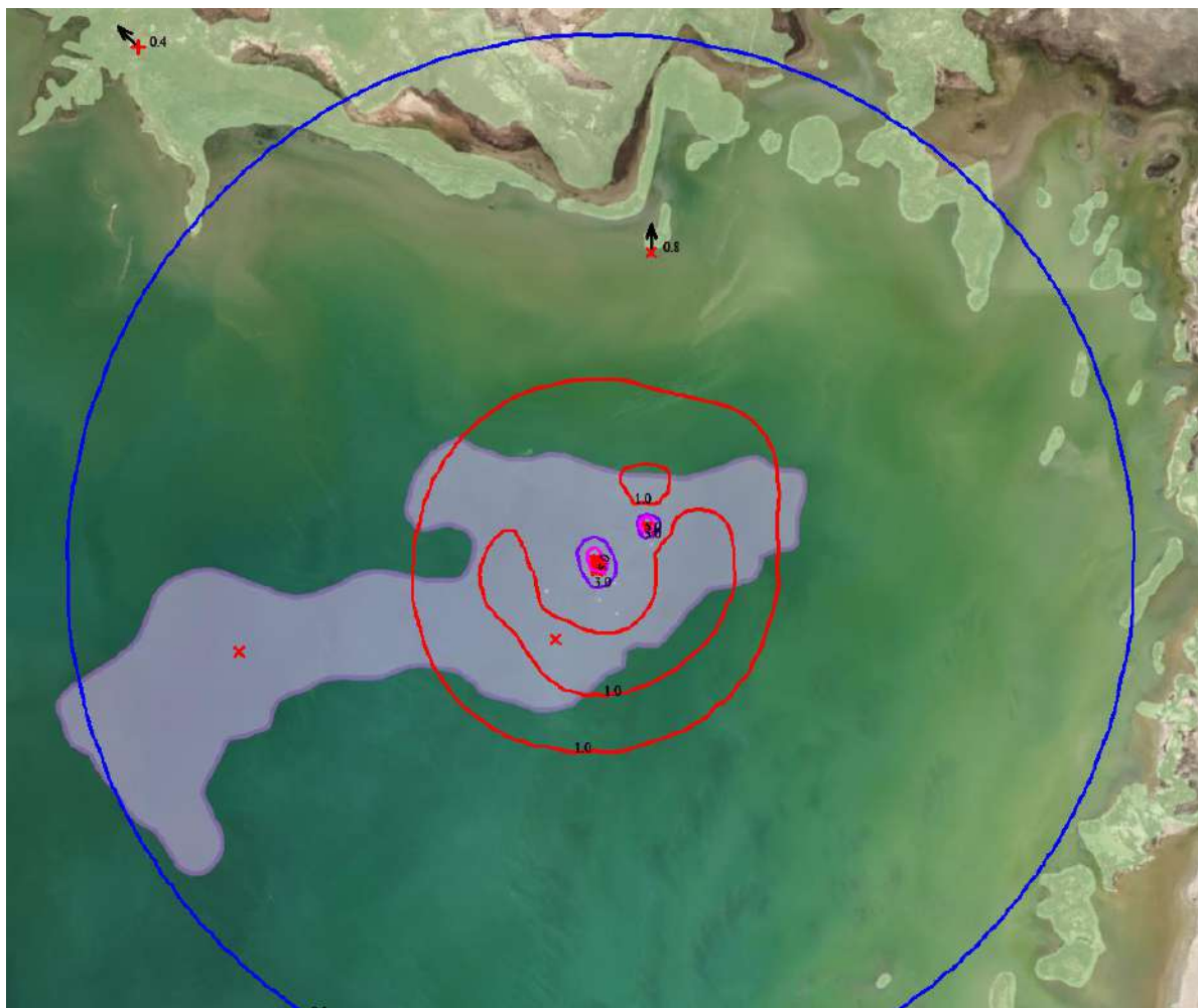
Рисунок 4.2.2 Результаты расчета рассеивания по группе суммации ( \text{NO}_2 + \text{SO}_2 ) при кратковременных периодических сбросах на факел
