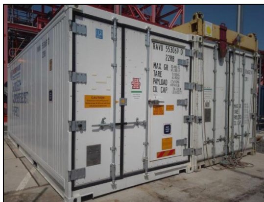
Фото 3 Морозильная установка контейнерного типа
